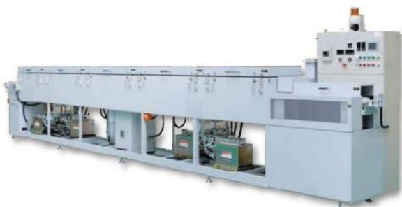
図 1. マイクロ波ゴム連続加硫装置(UHF)[1]
