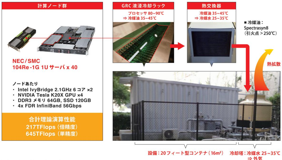
図1 Tsubame-KFCシステムの概要。
