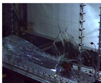
障害物のあるダムブレイク問題のシミュレーションと実験の比較
