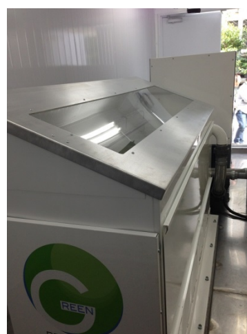
図：(左) GSIC 情報棟脇に設置されたコンテナ型装置 (右) コンテナの中に設置された液浸型ラック
