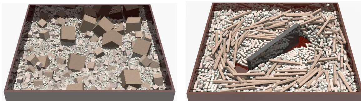
大きさの異なる 5 種類の立方体や棒状の物体の攪拌シミュレーション
