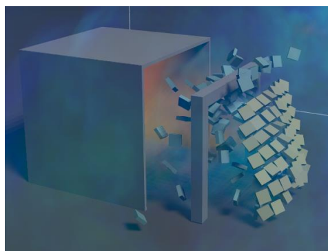
爆風による飛散物のシミュレーション (外殻や枠があり)
