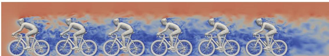
自転車 6 台直列走行時の乱れの速度プロファイル
