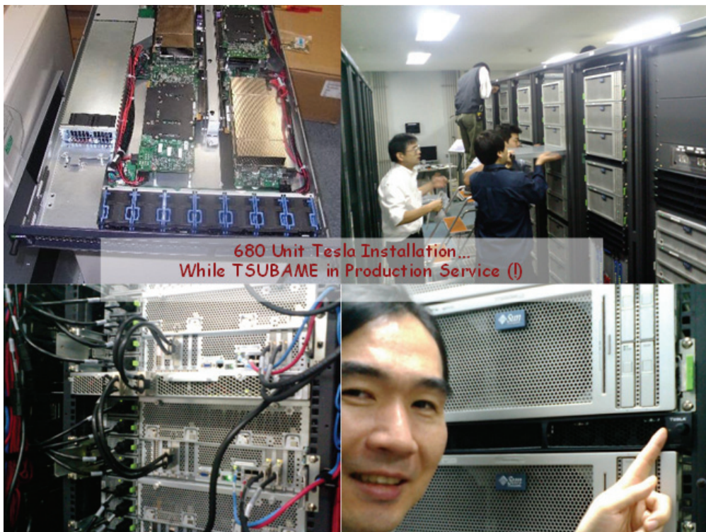
図 0.8 TSUBAME への NVIDIA Tesla S1070 の追加。それぞれの S1070 には Tesla 10p プロセッサカードが 4 枚内蔵されている。TSUBAME の計算ノード間に S1070 を挿入し、PCI-Express の拡張ケーブルで計算ノードに接続する。挿入後もほとんど目立たず、アクセラレータの高い計算密度を示している。
