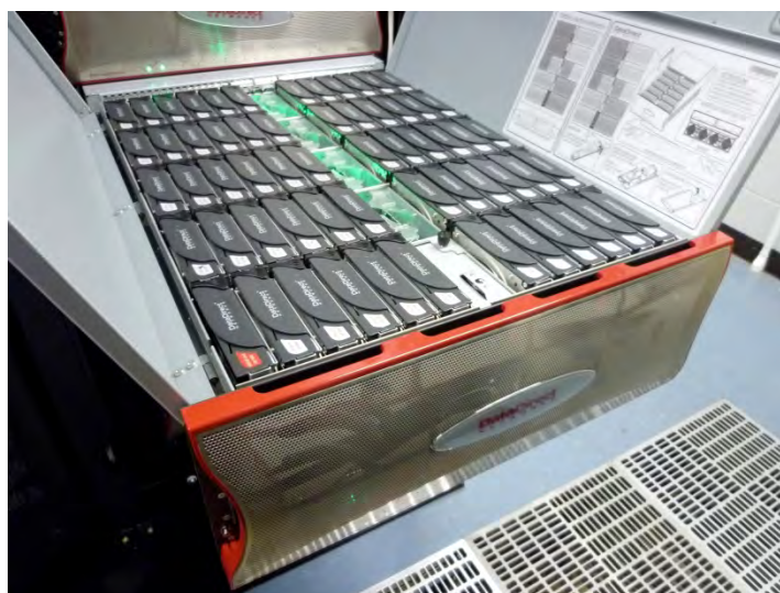
図 6: SFA10000 のディスクエンクロージャ内部には 60 台の 2TB SATA HDD
