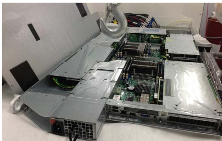
写真はメンテナンスのために引き上げた計算ノード。通常と異なり計算ノードを垂直方向に引き上げる必要があり、また滑りやすいためクレーンを利用している。引き上げたノードはラックの上に置き、冷媒液は拭き取らずに作業を行う。手馴れた作業員2名による引き上げ作業及びラックへ戻す作業はそれぞれ2分ほどで完了する。
