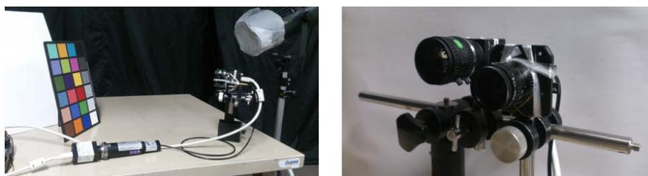
図 4 試作した複合解像度型分光イメージングシステムの全体 (左) とカメラヘッド (右)
