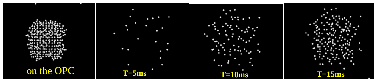
図4 転写前の OPC 上トナー像とベルト上の転写トナー像
