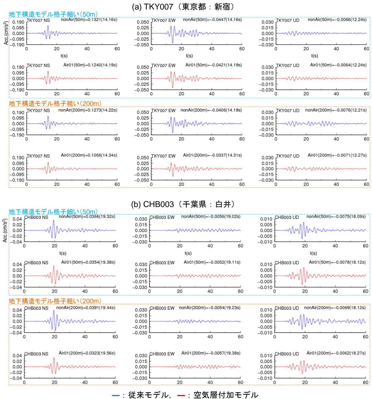
図 13 地下構造モデルの格子サイズを変化させた場合の従来モデルおよび空気層付加モデルの計算結果(加速度波形)の比較
