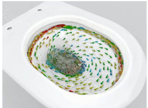
図10. 海外市場向け衛生陶器製品流れ (トレーサー微粒による内部流れの可視化)
