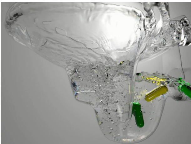
図9. 海外市場向け衛生陶器製品流れ (固体を含む内部の流れの可視化)
