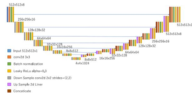
図1 提案 U-Net の構造
