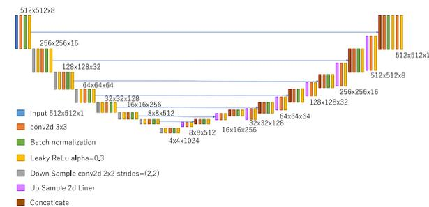
図 1 提案 U-Net の構造
