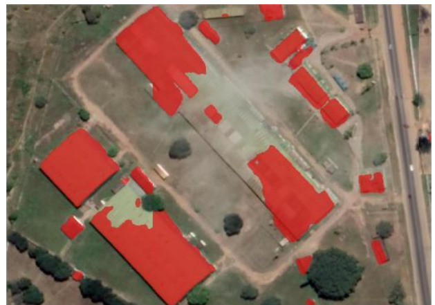
図 8 都市部の建造物検出の一部欠落の例
