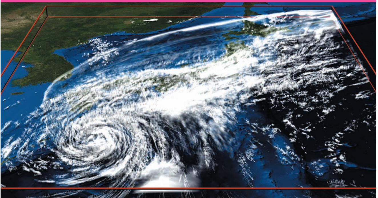
図6 台風の気象計算をTSUBAME 2.0の437 GPUを用い計算格子4792 × 4696 × 48 (水平500m格子)で単精度計算した例。雲を可視化している。
