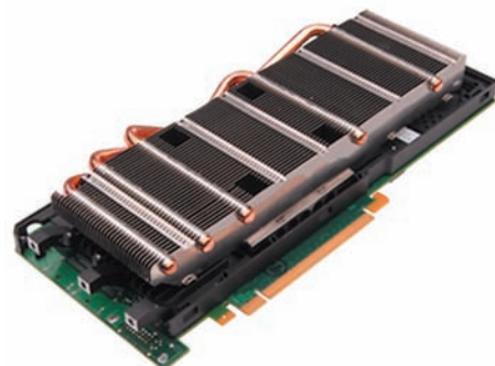
図4 TSUBAME2 で使用するNVIDIA Tesla M2050, Thin ノード1台に付き3機搭載
