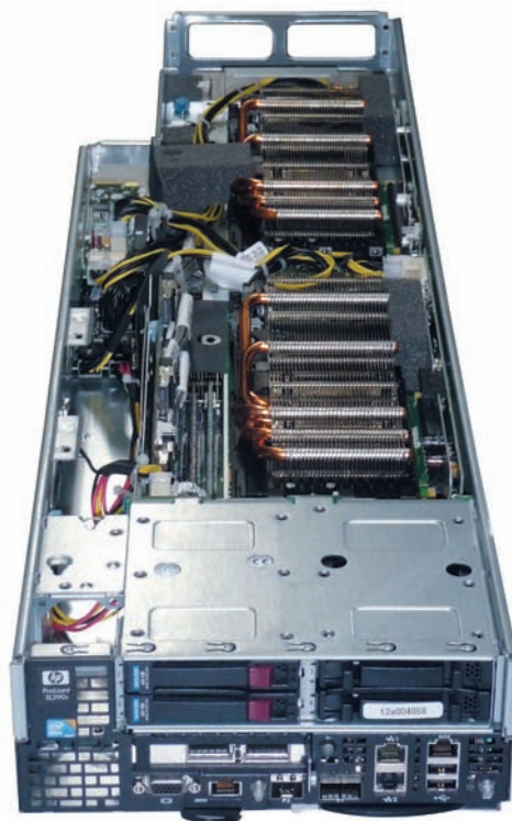
図6 TSUBAME1に比べ、サイズが1/4となったTSUBAME2計算ノード
