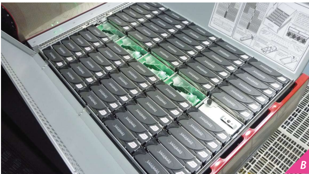
A 図7 TSUBAME 2.0 のLustre用ストレージサーバ群
