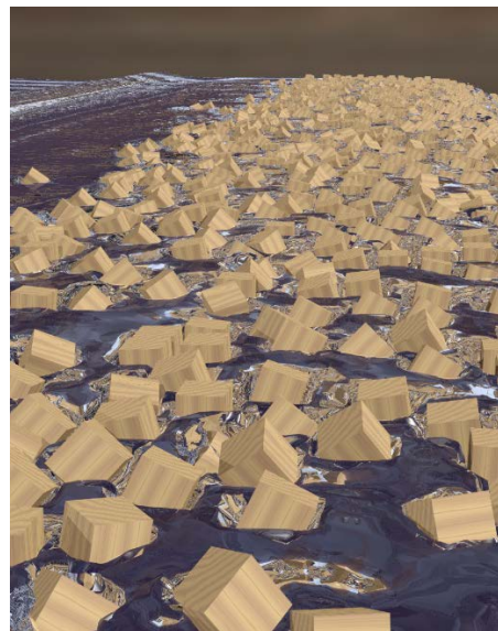
8743 万粒子, 2403 個の立方体の木片を含んだ 流体構造連成シミュレーション
