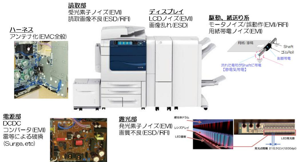
図 1 複合機を取り巻く EMC の概況
